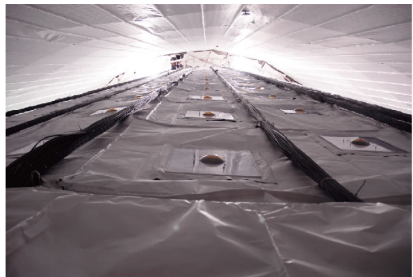
図 9 外水槽の底部から見上げた様子 内水槽側の壁に PMT が設置されており周囲は白い反射シートで覆われている
